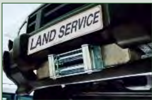
Platine Discrète porte-treuil Seulement pour certains types de treuil Pour Disco 200/300 - Réf: 1403 Pour Disco TD5 - Réf: 1417 Pour Disco 3 - Réf: 1422
